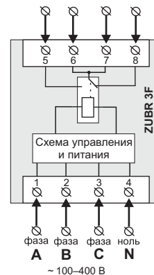
Схема 1. Упрощенная внутренняя схема и схема подключения.
