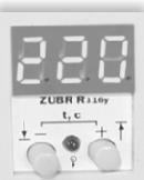
Потім починається індикація напруги мережі з блиманням на протязі 3 с. Якщо напруга мережі знаходиться в допустимих межах, тоді подається напруга на навантаження, при цьому починає світитись зелений світлодіод. Якщо напруга мережі перевищує верхню межу або нижче за нижню межу, тоді напруга на навантаження не подається, а значення напруги на індикаторі продовжує блимати.
