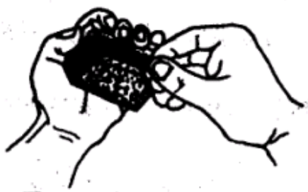
Рис. 20 Удалите нагар с игольчатого клапана
