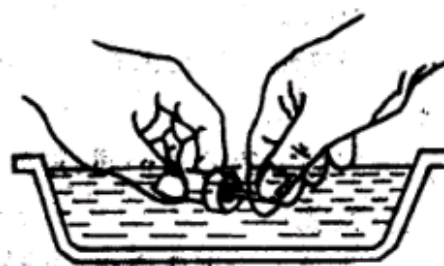
Рис. 21 Промойте корпус форсунки и игольчатый клапан
