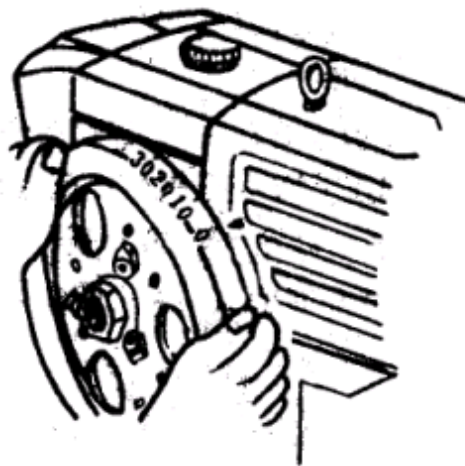
Рис. 18 Отметка ВМТ на маховике
