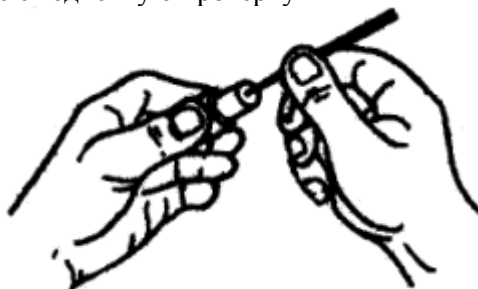
Рис. Удалите нагар с корпуса форсунки
