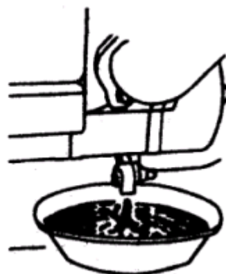
Рис. 16 Слейте охлаждающую воду
