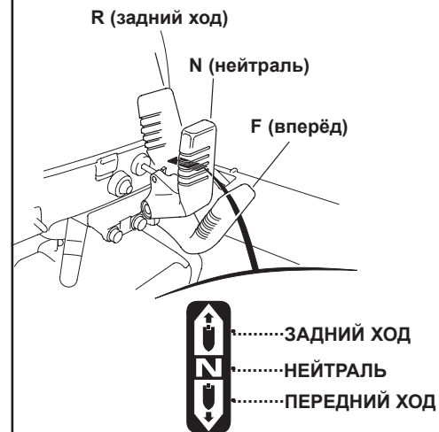
Ручка переключения хода (реверс) (модификация Н)
