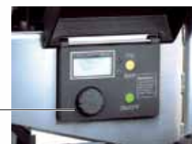
Контролер тиску з LCD екраном Екран індикації тиску в Бар або PSI
