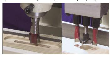
Вся операция по долблению квадратных отверстий и выбору пазов осуществляется вручную при помощи двух маховиков и длинной ручки, которая двигает голову с инструментом вниз в деталь и вверх после долбления, по массивной чугунной стойке с направляющими (макс. ход 200 мм).
