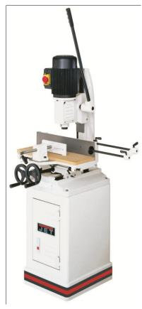
Станок достаточно компактный и не очень тяжёлый (125кг), при этом вся его конструкция, несущая нагрузки, сделана из качественного чугуна, а значит, при работе станок имеет хорошую прочность и точность. Ломаться в нём практически нечему,
