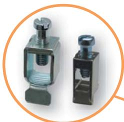
→ Зажимные клеммы на 2,5-4мм<sup>2</sup> выполнены монолитными (материал - латунь, покрытая слоем цинка и никеля), для исключения их деформации при зажатии. Оцинкованная закаленная сталь, из которой выполнены зажимы сечением более 6мм<sup>2</sup>, обеспечивает высокие характеристики усилий прижима провода. Все зажимы имеют специальный выступ для предотвращения попадания проводника в корпус клеммы.
