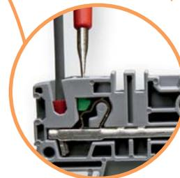
→ В случае необходимости проводник можно легко извлечь из клеммы нажатием отвертки на кнопку зеленого цвета. Эта кнопка изолирована от токоведущих частей, что является залогом электробезопасности персонала
