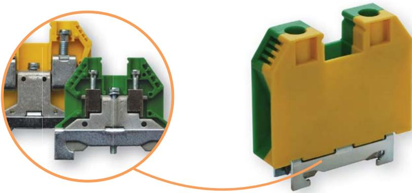
→ Винтовые заземляющие клеммы VS PE имеют конструкцию, состоящую из монолитного токопроводящего основания (выполненного из латуни и покрытого слоем цинка) и фиксатора (изготовленного из закаленной стали, покрытой слоем никеля), что обеспечивает надежное соединение и высокую проводимость.
