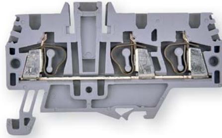
→ Пружинные заземляющие клеммы ESP-HTE для подключения проводников сечением от 0,2 до 25 мм<sup>2</sup> состоят из монолитного токопроводящего основания и фиксатора, что обеспечивает надежное соединение и высокую проводимость. Для уменьшения габаритов сборной конструкции клемма с одной стороны открыта. Возможна установка втычных перемычек
